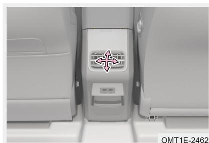
Spostare manualmente la leva di regolazione dell'uscita posteriore verso l'alto, verso il basso, verso sinistra o verso destra per regolare la direzione del flusso d'aria.
