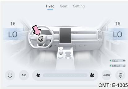
Dopo aver avviato il veicolo, premere "☀️" sullo schermo del sistema di climatizzazione per attivare la funzione di riscaldamento del volante, premere di nuovo o funzionare per circa 25 minuti, la funzione di riscaldamento del volante si spegne.
