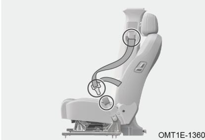
Controllare regolarmente le cinture di sicurezza per tagli, sfilacciamenti, cinture allentate e allungate (ad esempio dopo un incidente stradale). Se la cintura di sicurezza è danneggiata, contattare immediatamente una stazione di servizio autorizzata per l'ispezione e la riparazione.
