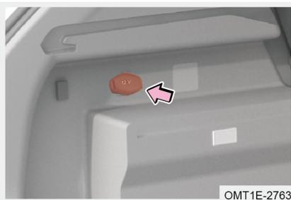
La presa di corrente posteriore si trova a sinistra del bagagliaio.
