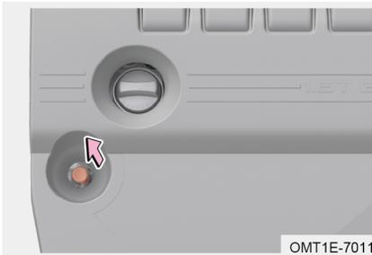
Con il motore fermo e raffreddato, controllare il livello dell'olio con l'astina di livello.
