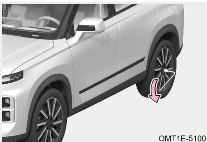
Passo 2: Montare la chiave per bulloni della ruota sul bullone del pneumatico sgonfio, posizionare la maniglia sul lato sinistro, tenere l'estremità della maniglia della chiave e spingerla verso il basso, allentare ogni bullone del pneumatico sgonfio di circa mezzo giro;
