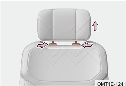
Rimozione dei poggiatesta: Tiri completamente il poggiatesta verso l'alto premendo i 2 pulsanti di rilascio del blocco.
