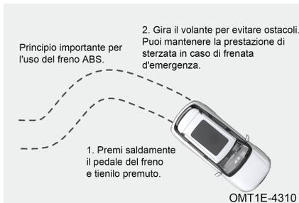
L'ABS non funziona durante la frenata normale e si attiva immediatamente solo durante la frenata improvvisa (il pedale del freno pulsa con rumore, garantendo le prestazioni del freno e dello sterzo, se lo spazio è sufficiente, il veicolo può anche evitare ostacoli). Non rilasciare mai il pedale del freno in questo caso.
