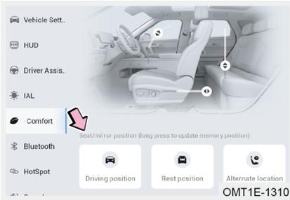
Accendere l'alimentazione del veicolo in modalità ON, il sistema audio visualizzerà la schermata di comfort del veicolo, selezionare la posizione di guida, la posizione di riposo o una posizione alternativa, premere a lungo per aggiornare e memorizzare.
