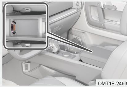
Mettere gli elementi necessari (ad esempio: Bevande in lattina) nella scatola per braccioli ausiliaria fascia per eseguire l'operazione di raffreddamento A/C. Ruotare il pulsante interno della scatola per braccioli per raffreddare gli oggetti necessari.
