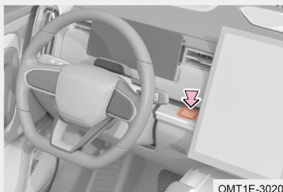
Passo 1: Fermare il veicolo e inserire il freno di stazionamento;
