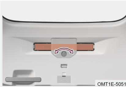
Triangolo di Avviso si trova sul pannello del portellone posteriore, girare il morsetto di fissaggio in senso antiorario per rimuoverlo.
