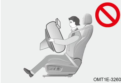
Mantenere sempre libera la traiettoria di apertura dell'airbag SRS. È vietato posizionare qualsiasi cosa (come un telefono cellulare) tra l'occupante e l'airbag SRS e fissare o posizionare oggetti sulla o vicino alla copertura dell'airbag SRS; se c'è un oggetto tra l'occupante e l'airbag SRS, l'airbag SRS potrebbe non attivarsi secondo il percorso di progettazione, oppure l'airbag SRS potrebbe spingere l'oggetto sul corpo dell'occupante, causando gravi lesioni o addirittura la morte.
