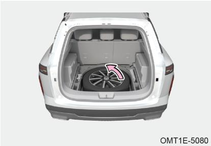
Passo 2: Ruotare il dispositivo di fissaggio della ruota di scorta in senso antiorario per rimuoverlo, quindi estrarre la ruota di scorta.
