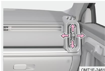
Spostare la leva di regolazione dell'uscita laterale sinistra/destra verso l'alto, verso il basso, verso sinistra o verso destra per regolare la direzione del flusso d'aria.
