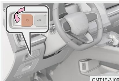
Quando l'alimentazione del veicolo viene commutata in modalità ON, o il motore viene avviato e il veicolo si ferma, tirare il pulsante del freno di stazionamento elettrico, l'indicatore rosso " (P) " nel quadro strumenti e l'indicatore del pulsante del freno di stazionamento elettrico rimangono accesi, indicando che la funzione del freno di stazionamento è stata attivata.
