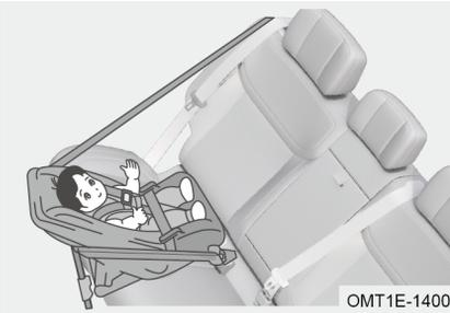
Un sistema di ritenuta per bambini rivolto all'indietro è installato in modo da essere rivolto verso la parte posteriore del veicolo. Installi un sistema di ritenuta per bambini rivolto all'indietro sul sedile del passeggero anteriore solo se l'airbag è disattivato. Si consiglia di utilizzare un sistema di ritenuta per bambini rivolto all'indietro fino a 4 anni.
