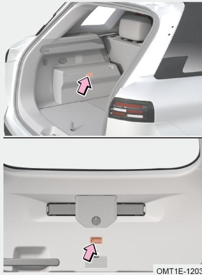
Quando si apre il portellone posteriore, la luce del bagagliaio si accende automaticamente per alcuni secondi. Quando il portellone posteriore è chiuso, la luce del bagagliaio si spegne immediatamente.
