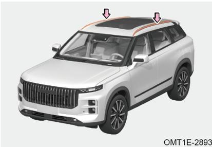
Il portapacchi sul tetto è utilizzato per caricare carichi che possono trasportare merci da 75 kg. Il sovrappeso comporterà il portapacchi, il tetto del corpo e altri componenti per essere danneggiati, i vari problemi causati dal sovrappeso non sono all'interno delle rivendicazioni.
