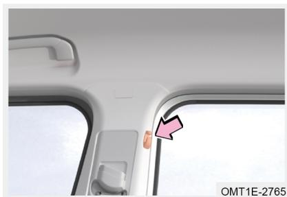
I ganci per cappotti sono situati sulla parte superiore della piastra di rivestimento B-pilastro.
