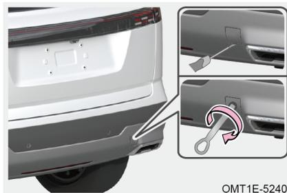
Passo 1: Per rimuovere il coperchio del foro dell'occhiello di traino posteriore, utilizzare un cacciavite con la punta nastrata.
