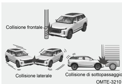
L'airbag del guidatore, l'airbag del passeggero anteriore e l'airbag per le ginocchia del guidatore potrebbero non attivarsi se la parte anteriore del veicolo urta un palo telegrafico, passa sotto un camion o se il veicolo è coinvolto in una collisione laterale.
