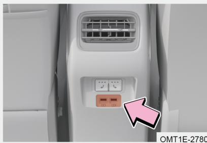
La porta USB posteriore può essere utilizzata per ricaricare le apparecchiature elettriche a bassa potenza, come il telefono, ecc.
