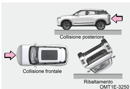
Gli airbag laterali, gli airbag a tendina e l'airbag centrale anteriore potrebbero non attivarsi se il veicolo subisce una collisione frontale o posteriore, una rotazione o una collisione laterale a bassa velocità.
