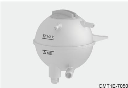
A motore freddo, il livello del refrigerante deve essere compreso tra i segni "MIN" e "MAX". Se il livello è pari o inferiore al segno "MIN", aggiungere il refrigerante e contattare immediatamente il centro assistenza autorizzato per l'ispezione e la riparazione.
