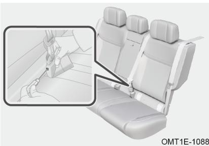
Quando si inserisce la linguetta di blocco nella fibbia piccola del lato sinistro del sedile di seconda fila, utilizzi un cacciavite con la punta avvolta da nastro adesivo o un oggetto simile per premere la posizione indicata nell'illustrazione ed estrarre la linguetta di blocco.
