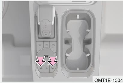
Metodo 2: Dopo aver avviato il veicolo, premere l'interruttore del riscaldatore del sedile anteriore sulla console ausiliari. È un riscaldamento a 3 livelli (3 indicatori accesi). Ogni volta che si preme l'interruttore, il livello di riscaldamento si riduce di un livello. Prema la quarta volta per spegnere il riscaldamento dei sedili.
