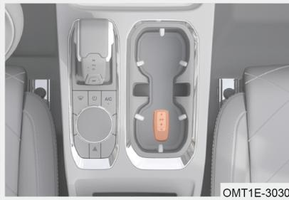
Passo 1: Posizionare la chiave intelligente sull'apposito contrassegno del portabicchieri della console della fascia ausiliaria (come mostrato in figura) con la parte anteriore rivolta verso l'alto; in questo momento non premere il pedale del freno;
