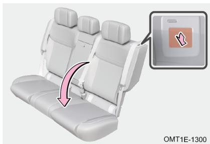
Regoli l'altezza dei poggiatesta dei sedili. Li rimuova se necessario e ripiegare il bracciolo centrale. Quindi tiri la maniglia di regolazione dello schienale sinistro in avanti e tiri lo schienale in avanti per abatterlo lentamente. In questo modo è possibile ampliare lo spazio di stivaggio del bagaglio.
