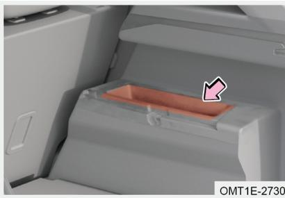
Ci sono le scatole di stoccaggio sui lati sinistro e destro del vano bagagli. Il peso massimo della scatola di stoccaggio è di 10 kg.
