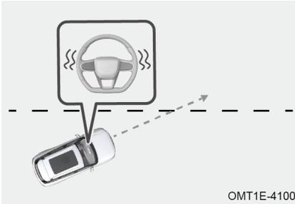
Quando la velocità del veicolo non è inferiore a 65 km/h e la linea di corsia è riconosciuta, l'LDW entra in stato di attesa.
