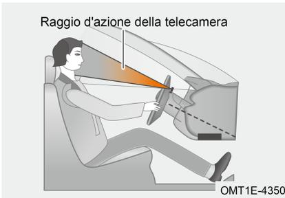
Il sistema di monitoraggio del conducente utilizza la telecamera a infrarossi disposta sul volante per monitorare e raccogliere l'immagine del viso del conducente (come sbadigli, occhi chiusi, annuire, ecc.) e le informazioni sull'area del campo visivo in tempo reale, raccogliere e giudicare lo stato del conducente in tempo reale.
