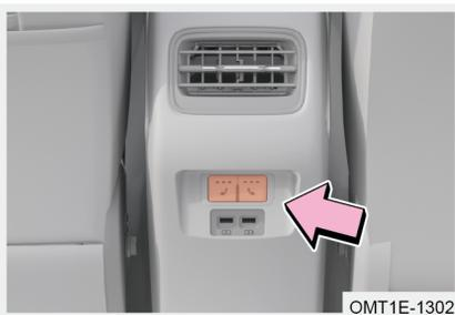
Metodo 2: Dopo aver avviato il veicolo, premi l'interruttore del riscaldamento del sedile posteriore. Il riscaldamento è a 3 livelli (3 indicatori accesi). Ogni volta che si preme l'interruttore, il livello di riscaldamento si riduce di un livello. Prema la quarta volta per spegnere il riscaldamento dei sedili.
