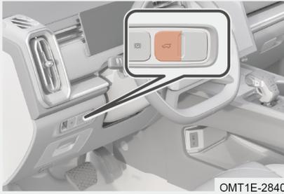
Con lo sblocco del blocco del comando centrale, premere a lungo l'interruttore "
