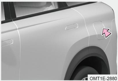
Passo 1: Dopo che il veicolo è sbloccato, spingere il tappo del serbatoio del carburante e si aprirà;
