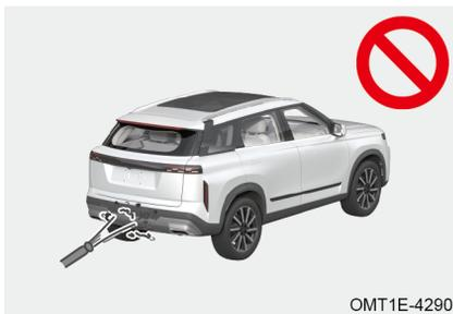
Quando si lava il veicolo, utilizzare un panno morbido o acqua (a bassa pressione) per lavare via corpi estranei come neve, fango e polvere sulla superficie del sensore radar.
