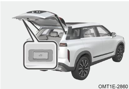
Metodo 1: Dopo il portellone posteriore elettrico è aperto, regolarlo all'altezza desiderata; premere a lungo l'interruttore "🚗" finché il veicolo non emette un segnale luminoso e l'altezza di apertura del portellone posteriore elettrico è stata impostata correttamente.
