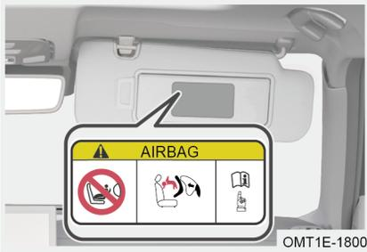
Questo adesivo è attaccato all'aletta parasole del passeggero anteriore e serve a ricordare che il veicolo è dotato di airbag anteriore (SRS). Osservare le seguenti precauzioni:
