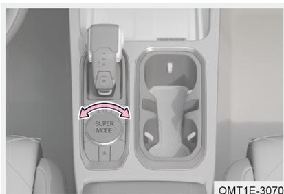
Il sistema è in modalità ECO per impostazione predefinita all'avvio del motore. Ruotare la manopola della modalità di guida tra la modalità SPORT, la modalità ECO o la modalità NORMAL. È possibile scegliere in base alle diverse condizioni stradali.
