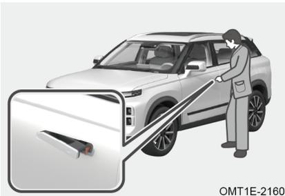
Passo 2: Tiri la maniglia della portiera, inserisca la chiave meccanica nel buco della serratura all'interno della maniglia della portiera, giri in senso orario per bloccare la portiera, in senso antiorario per sbloccarla.
