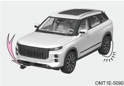
Passo 1: Mettere un blocco sotto il pneumatico diagonalmente opposto a quello sgonfio per evitare che il veicolo si muova.
