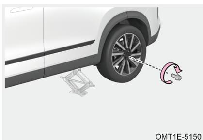
Passo 2: Quando si installano i bulloni delle ruote, avvitare manualmente tutti i bulloni in senso orario. Quindi raddrizzare la ruota di scorta e pre-serrare tutti i bulloni delle ruote con la chiave per bulloni della ruota;
