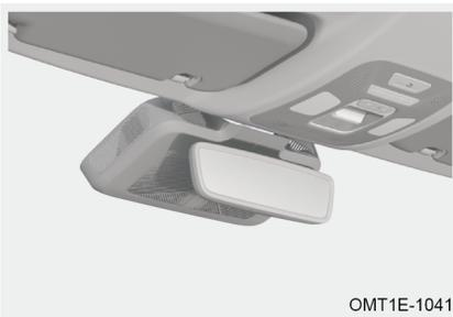
Durante la guida notturna, il sensore di luminosità installato davanti/dietro allo specchietto retrovisore interno rileva automaticamente la luce riflessa dai fari dei veicoli retrostanti e regola automaticamente l'angolo della lente per ridurre la luce riflessa dai fari dei veicoli retrostanti.
